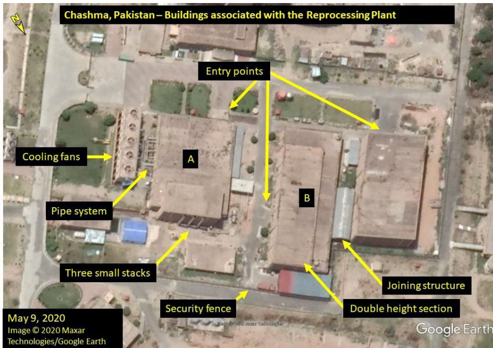
Immagine. Visibile chiave caratteristiche Di due Di IL originale edifici associato con IL Impianto di separazione del plutonio.
