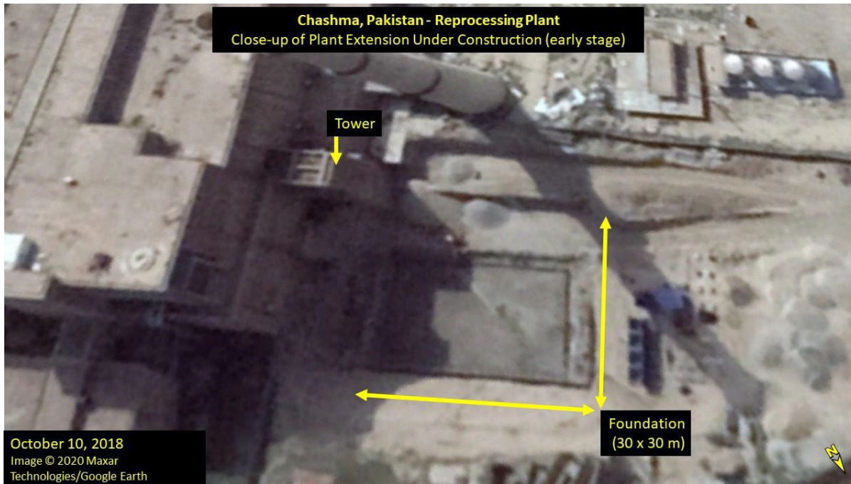
תמונה. עד אוקטובר 2018, בסיס בגודל 30 על 30 מ' עבור הרחבה מתחת לפני הקרקע נראה בתמונות של Google Earth.
