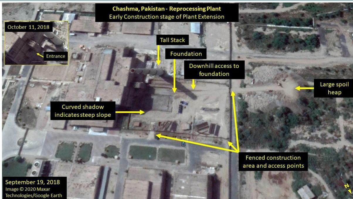
**Immagine.** La costruzione dell'ampliamento dell'impianto di separazione del plutonio in una fase iniziale nel settembre 2018.
