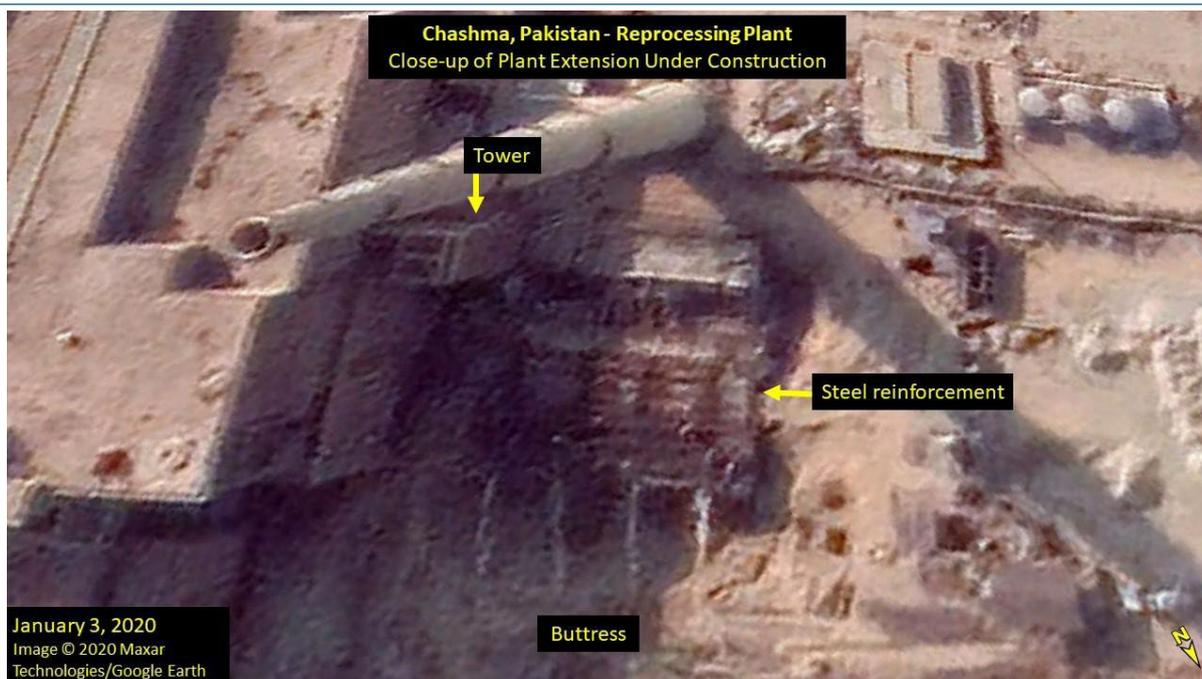
**Immagine.** Più di un anno dopo, nel gennaio 2020, la costruzione dell'ampliamento è proseguita in altezza con rinforzi in acciaio.
